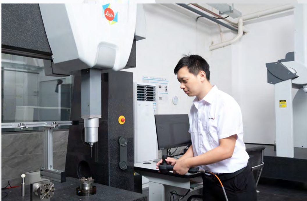
HEXAGON 海克斯康三坐标测量仪 SAGER 06.08.06 行程范围：600*800*600，长度测量误差： E_0=0.6+L/400\mu\text{m} ，重复精度：0.5 \mu\text{m}
