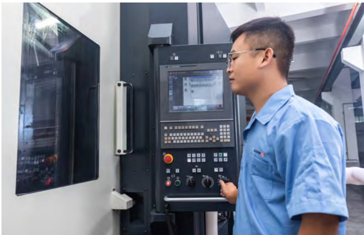
MAKINO 牧野卧式加工中心 a81NX 轴向行程：900*900*1020，X、Y、Z轴光栅反馈0.05 \mu m
