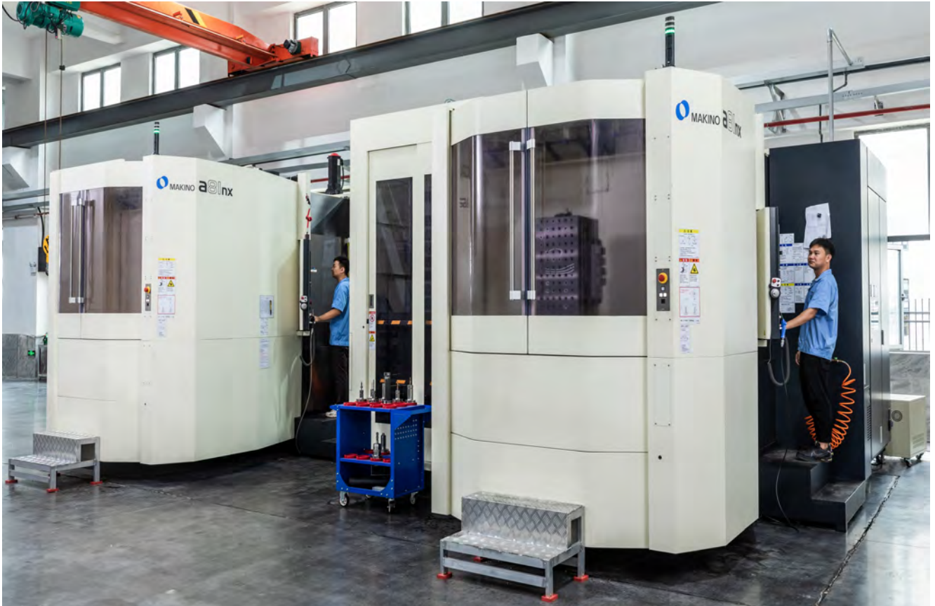
MAKINO 牧野卧式加工中心 a81NX 轴向行程：900*900*1020，X、Y、Z轴光栅反馈0.05 \mu m
